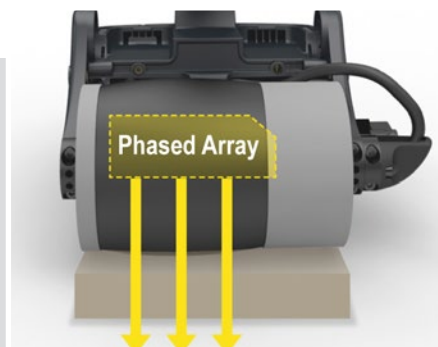
Performances acoustiques ; pneu ultra résistant. Une large couverture active de 51 ou 102 mm et une hauteur d'eau de 25mm pour des épaisseurs d'environ 100mm d'acier et 50mm dans CFRP.
