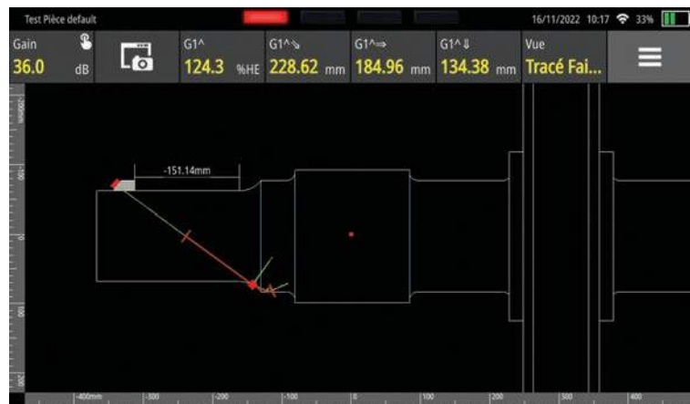
Importation d'un fichier CAO d'essieu ferroviaire.
