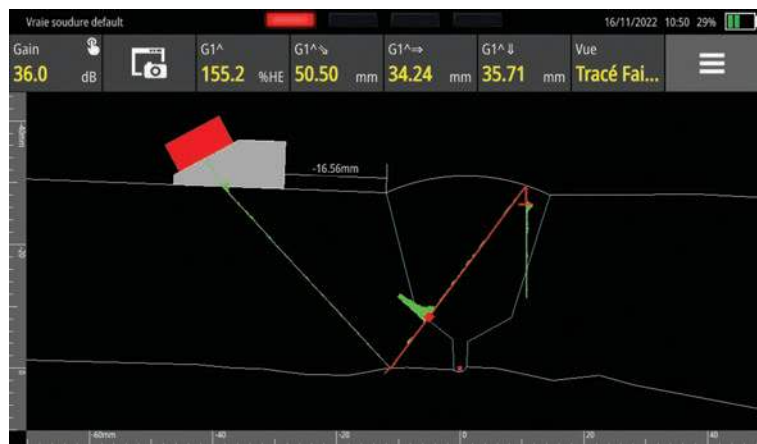
Utilisation d'un fichier de soudure importé après mesure du profil réel.
