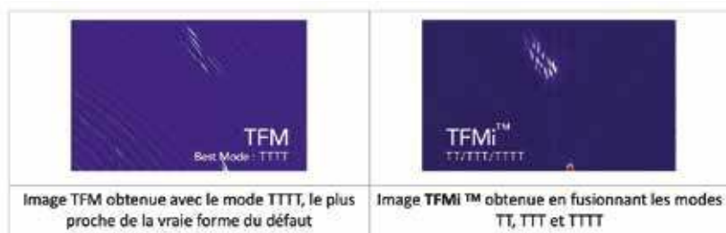
Exemple de l'intérêt du TFMi sur un amas de porosités.
