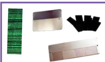
**Cales NF EN ISO 3452-3 type 1** (NiCr Tesco) & **type 2**, plaquettes **Runcheck, TAM panel Hoffmann** (équivalent PSM-5).
