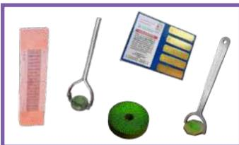
Pour les conditions d'aimantation : **croix de Berthold, témoin ASME, indicateurs Castrol, cale et disque SNECMA.**
