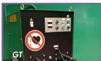
Gamme de générateurs de courant mobiles très puissants de 4 000 (GT-4) à 18 000 A crête (GT-18). Passage de courant par touches de contact ou autres, passage de champ par enroulement de câble de puissance ou solénoïde externe. Courant alternatif pour GT-x plus R1A pour GT-xP.
