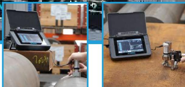
L'**Equotip 550** est une plate-forme de mesure de duret  qui permet d'utiliser de nombreux mod les de sondes avec diff rentes m thodes de mesure de duret  : mesures par rebond de bille (m thode Leeb), mesure par micro-empreinte Rockwell, mesure par m thode ultrason (m thode UCI). Cet appareil dispose d'assistants de configuration pour vous aider   d terminer la m thode la plus adapt e   votre application. L'**Equotip 550** est un appareil haut de gamme qui offre une tr s grande pr cision.
