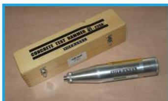
Le **SCLÉROMÈTRE** est un appareil de mesure de dureté par choc permettant d'évaluer la résistance du béton.
