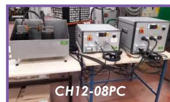
**Gamme de bancs polyvalente et économique** pour la formation, la prestation et autres. Passage de courant (électrodes), passage de champ (solénoïde ou têtes magnétiques), AC, R1A. Intensité selon modèle. Cabine disponible en option.
