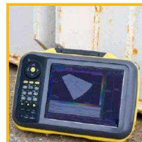
Le **PRISMA** dispose des outils de simulation 3D pour paramétrer votre cordon de soudure et construire votre réglage en vérifiant chaque étape. Ceci permet de positionner rapidement et sans erreur les indications dans le volume de la pièce et de faire figurer le schéma dans le rapport de contrôle.
