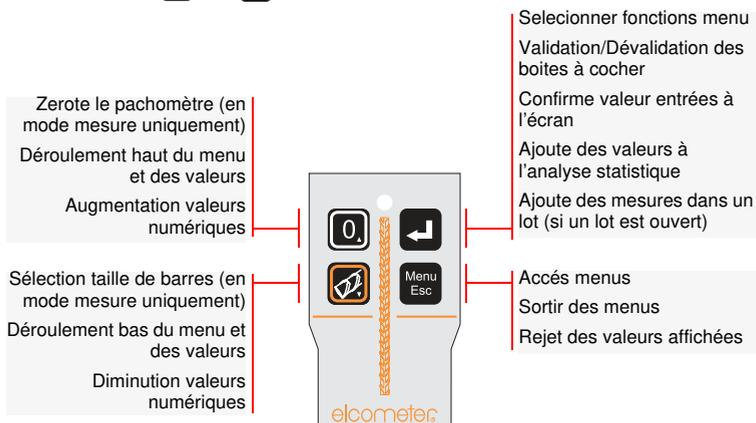
Figure 7. Clavier sonde
