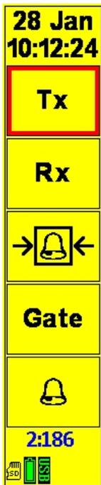
La programmation des icônes de la barre latérale s'effectue via l'écran de menu. Pour supprimer l'une des 4 icônes supérieures, sélectionnez l'icône inutile et appuyez longuement (3 secondes) sur la touche Retour/Menu.
