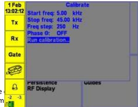
10. Appuyer fermement le palpeur sur une zone de la pièce éloignée du défaut et appuyer à nouveau sur la softkey
