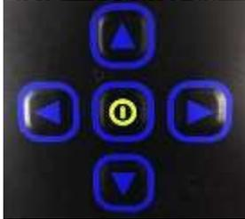
Une pression longue (plus de 3 secondes) sur la touche centrale/entrée permet d'allumer et d'éteindre l'instrument. Les 4 touches fléchées rouges sont des touches de curseur qui permettent de naviguer dans le système de menus et de modifier les valeurs des paramètres.
