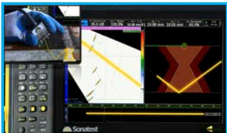
Les outils de modélisation intégrés dans le VEO+ prennent en charge plusieurs sondes et balayages, ce qui permet de configurer rapidement et efficacement les plans d'inspection. Choisissez parmi une gamme de géométries de soudure et visualisez la ou les sondes sur la pièce, en représentant la réalité avec une grande fidélité. Puis augmentez le parcours sonore, pour afficher plusieurs bonds, afin d'évaluer et assurer une couverture adéquate comme prévu dans le plan de balayage.
