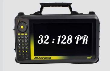
Contrôle de soudure de forte épaisseur
