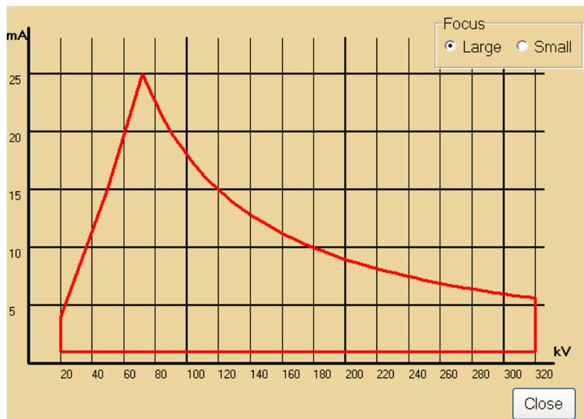
NOTE: La courbe de charge peut varier en fonction du générateur HT utilisé
