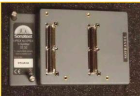
Splitter Y, permet de connecter 2 sondes PA simultanément sur votre électronique.
