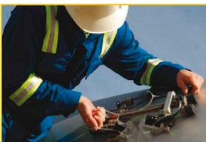
Large gamme de scanners permettant de déplacer plusieurs sondes simultanément, ici le STIX.
