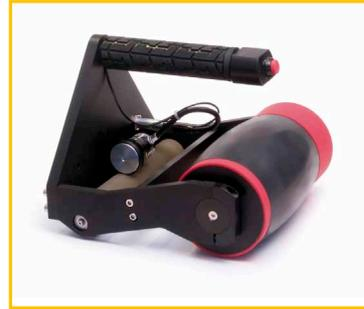
La fameuse roue Phased Array brevetée par Sonatest est le fruit de nombreuses années de recherche et d'un développement méticuleux. Elle est caractérisée par un large pneu en caoutchouc déformable dont l'impédance acoustique est adaptée à celle de l'eau. On génère ainsi une faible perte de couplage dans la pièce à contrôler, et donc des résultats de bonne qualité sans avoir recours à du gel, ni à de grandes quantités d'eau.
