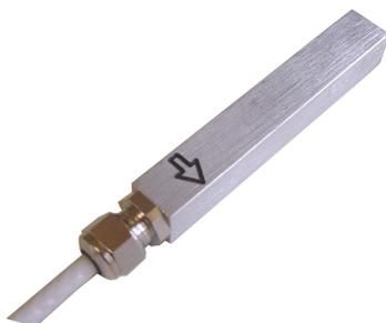
La sonde droite offre une bonne stabilité au contact de la pièce. Elle s'utilise en plaquant l'extrémité de la sonde sur la surface où se trouve le champ tangentiel à mesurer.
