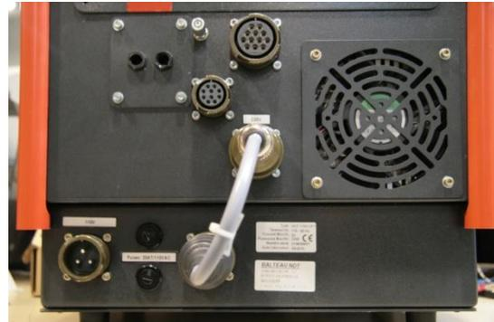
Maintenant votre kit 110V est correctement connecté avec la DCP et peut être utilisé suivant les instructions indiquées dans le manuel.
