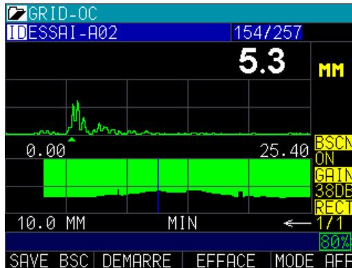
Ce mode vous permet de valider que la mesure d'épaisseur minimum s'est bien faite sur un écho de fond et non sur un parasite ou sur une irrégularité de surface.
