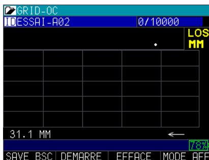
Appuyez alors sur la touche <F2> pour démarrer l'acquisition. Suivant votre choix sur le paramètre BSCAN LOSS (Pause ou Continue), l'acquisition va démarrer si le traducteur est couplé. Noter en bas à gauche l'échelle d'affichage, ici 31,1 mm. Noter en haut à droite de l'écran l'indicateur de place restante pour le profil BScan. Ici 10 000 mesures d'épaisseurs vont pouvoir être stockées.
