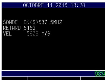
NOTE : Un message d'alerte va s'afficher si la mesure de la ligne à retard est en dessous de la limite pour pouvoir faire des mesures précises. Vous devez remplacer le traducteur ou sélectionner la touche <F1> pour accepter le message d'alerte et continuer à utiliser le même traducteur.
