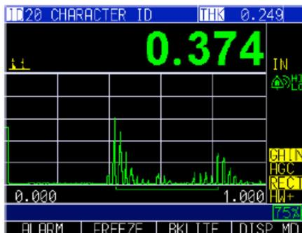
Autre exemple d'affichage avec visualisation du signal AScan. Différents modes d'affichage existent en fonction des options qui sont installées sur votre appareil. Pour changer de mode d'affichage, appuyer sur la touche <F4> (DISP MD sur l'exemple ci-dessus) pour changer de mode. Appuyer successivement sur cette touche pour basculer d'un mode à l'autre jusqu'à revenir à l'affichage initial.
