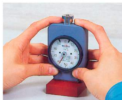
Position des mains sur le duromètre pour un bon contrôle
