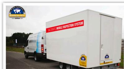
*En plus et grâce au fait d'être compacte, l' AIS958 peut être installé dans une remorque le rendant ainsi mobile. Un opérateur pourra dès lors se déplacer afin de réaliser des radiographies à tout moment et donc de pouvoir offrir une réponse rapide et efficace pour un client.*
