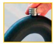
Mesures sur pièces en caoutchouc type durites ou tuyauteries.
