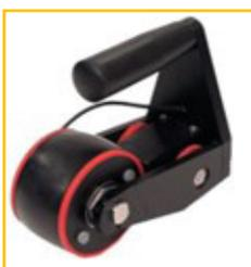
Disponible également en version mono-élément, avec une sonde immersion de 15mm, de 2, 5 et 10 MHz. Elle dispose d'un pneu basse pression de 38 mm et est équipée d'un codeur de positionnement qui peut être connecté à n'importe quel appareil de recherche de défauts.
