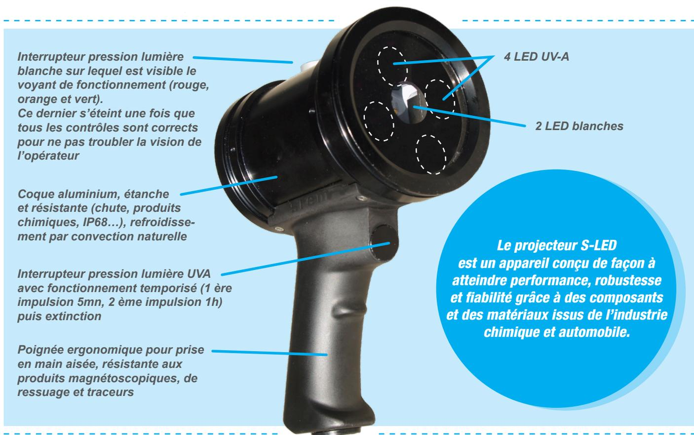
Deux versions différentes de projecteurs S-LED ont été développées, se déclinant sur secteur et/ou sur batterie : 1 à bords larges conforme à toutes les exigences et 1 sans filtre UV conforme à l'ISO 3059 pour le contrôle des pièces brutes ou pour la détection de fuite par traceur fluorescent
