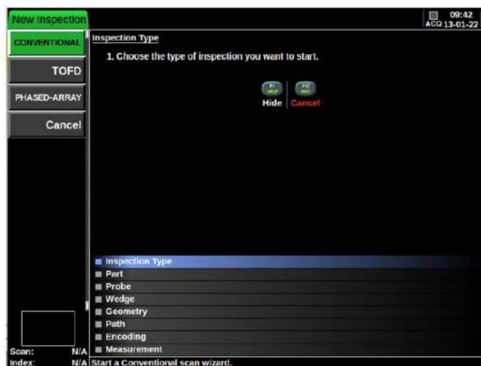
4. Sélectionner le type d'inspection ( US conventionnel, TOFD ou multiélément) et appuyer sur
