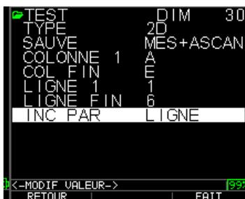
L'exemple ci-dessus montre un fichier 2D avec une sauvegarde automatique du Ascan associé à chaque mesure. La capacité maximum de stockage est de 5000 mesures d'épaisseur par fichier ou 160 Ascan. Le mesureur calcule automatiquement la taille du fichier en fonction des
