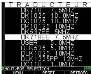
Lors de la mise en route du mesureur, vous pouvez vérifier la référence du traducteur (gravée sur le boîtier) et vérifier que celle-ci est bien en correspondance avec celle sélectionnée sur le mesureur.
