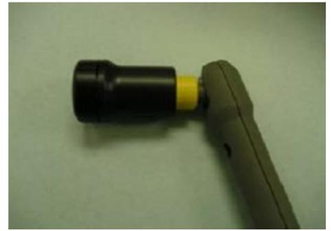
Vissez à la main la bague de serrage dans le sens des aiguille d'une montre jusqu'à ce que la connexion soit sûre.
