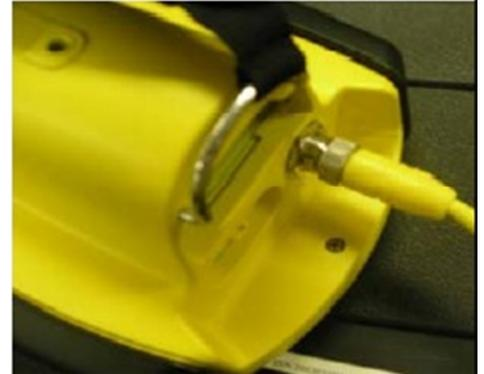
Les bagues de serrage des câbles sont usinées de manière précise et faites pour être vissées à la main. Ne jamais utiliser un outil pour fixer les connexions. L'utilisation d'un outil peut entraîner des dommages qui ne sont pas couverts par la garantie.
