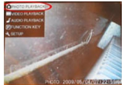
A chaque fois que l'utilisateur sélectionne "Photo Playback", le curseur reste sur la dernière image prise et l'utilisateur peut utiliser les touches haut et bas sur le clavier face avant pour placer le curseur sur la photo qu'il désire revoir.
