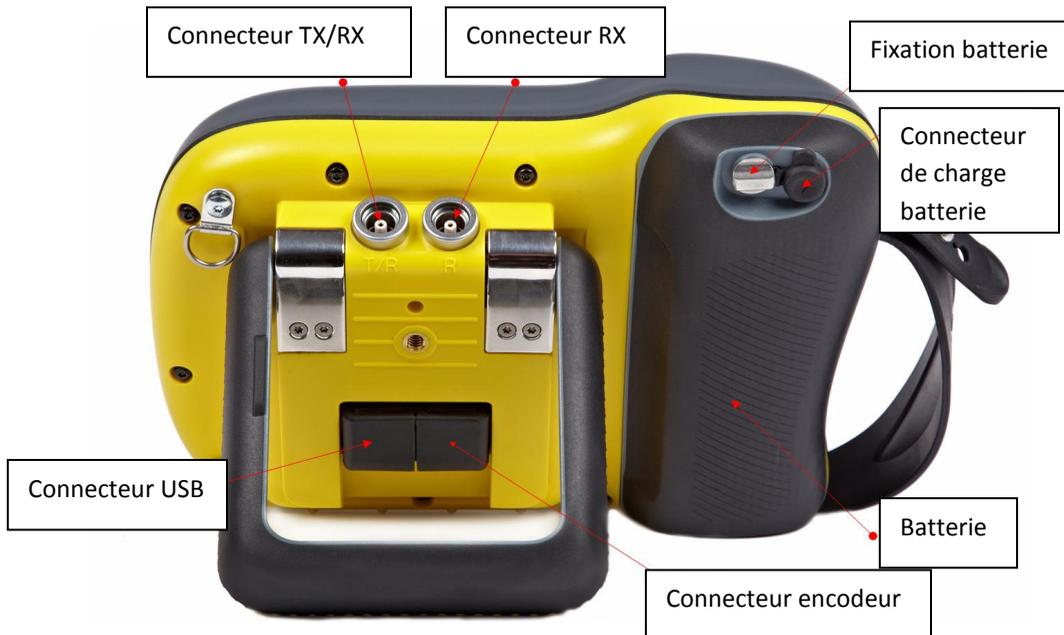
Lorsque vous connectez votre appareil à un PC en utilisant l'USB, vous pouvez mettre à jour le logiciel software et firmware.
