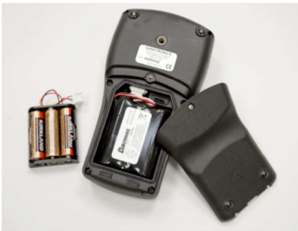
Si vous utilisez des batteries rechargeables AA, celles-ci doivent être rechargées à l'extérieur de l'appareil. Ne pas chercher à recharger les batteries en utilisant le port USB.
