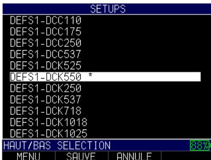
Lors de la mise en route du mesureur, vous pouvez vérifier la référence du traducteur (gravée sur le boîtier) et vérifier que celle-ci est bien en correspondance avec le réglage sélectionné sur le mesureur.
