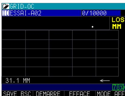
Appuyez alors sur la touche <F2> pour démarrer l'acquisition. Suivant votre choix sur le paramètre BSCAN LOSS (Pause ou Continue), l'acquisition va démarrer si le traducteur est couplé. Noter en bas à gauche l'échelle d'affichage, ici 31,1 mm. Noter en haut à droite de l'écran l'indicateur de place restante pour le profil BScan. Ici 10 000 mesures vont pouvoir être stockées.
