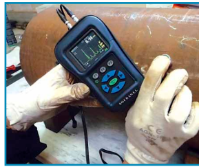
Des mesureurs d'épaisseurs
