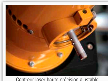
Centreur laser haute précision ajustable
