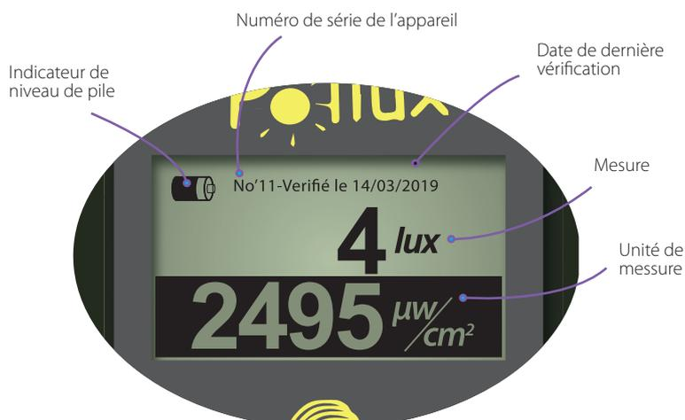
La sonde se trouve dans un boîtier déporté, relié au boîtier de mesure par un câble d'un mètre de longueur. Cette unique sonde permet la mesure de la lumière visible et des UV-A.
