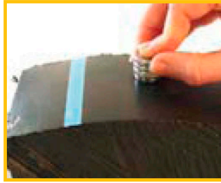
Mesures sur tuyauteries en polyéthylène de forte épaisseur.
