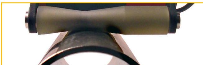
Un balayage longitudinal sur tube ou cylindre est également facile à réaliser. Le diamètre minimum pour cette application est toujours limité à 4" (100mm). Pour le balayage longitudinal, il a fallu adapter la construction du capteur à roue corrosion et développer un rouleau avant spécifique. Sur des tubes de diamètres inférieurs à 24" (610mm), cet accessoire améliore la stabilité en épaulant le pneu. Il permet d'optimiser les résultats sur une large gamme de diamètres de tubes.
