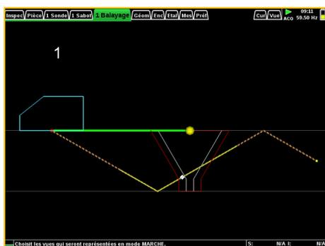
La visualisation Scan 3D permet de visualiser la position de l'indication dans la pièce en intégrant le profil de la soudure par exemple et de la ZAT.
