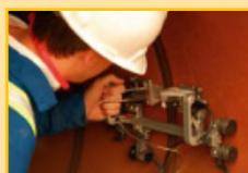
du simple « porte sondes » avec roue codeuse, aux scanners plus spécifiques avec 4 portes sondes ou plus, roues magnétiques, mise en forme pour contrôle sur soudures circulaires ou longitudinales.
