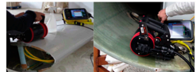
FIGURE 11 : Inspection de pales d'éolienne à l'aide la WheelProbe « Jumbo » 0,5 MHz.
