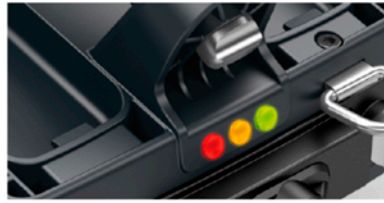
FIGURE 3 : Présence de LED à l'arrière de la sonde Sonatest WP2.
