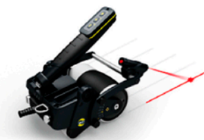
FIGURE 10 : Laser de guidage réglable en position le long des lois de retard.
