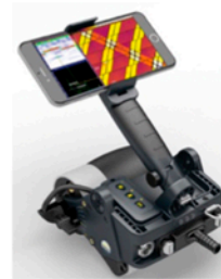
FIGURE 4 : Utilisation d'un smartphone fixé sur la poignée de la WheelProbe pour visualiser l'acquisition en temps réel.
